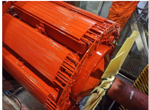
Rotor principal antes e após da limpeza com gelo seco e pintura
